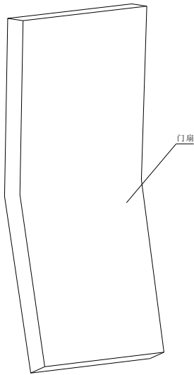
图11 门扇高度方向弯曲度示意图
